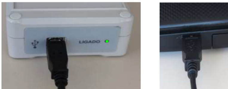
Figura 6 - Conexão cabo USB - Cardiofit USB/Computador
