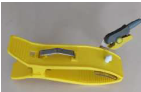
Figura 9 - Conexão cabo do paciente - eletrodos
